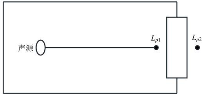
图 5.4-1 室内声源等效为室外声源图例
