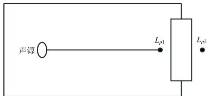
图 5.4-1 室内声源等效为室外声源图例
